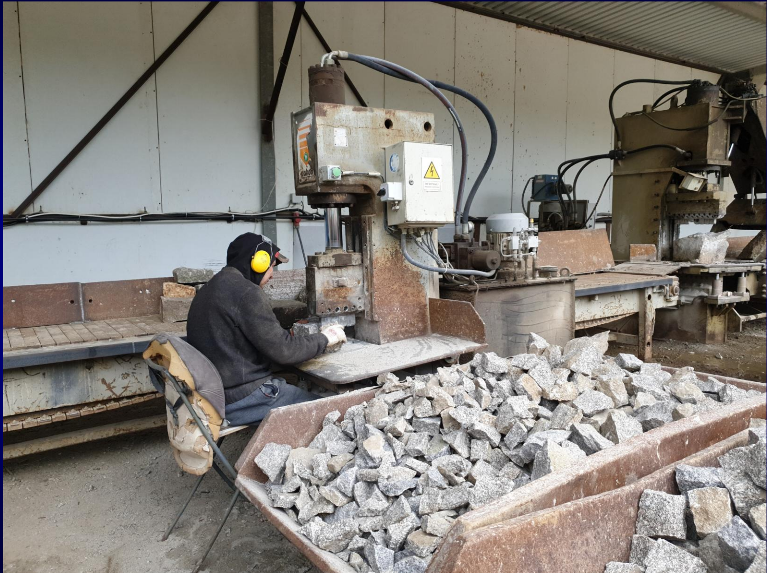
Ručně se zde vyrábějí žulové kostky
