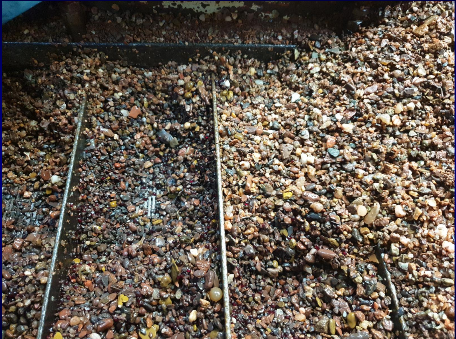
Hledání českých granátů v koncentrátu na třídící lince
